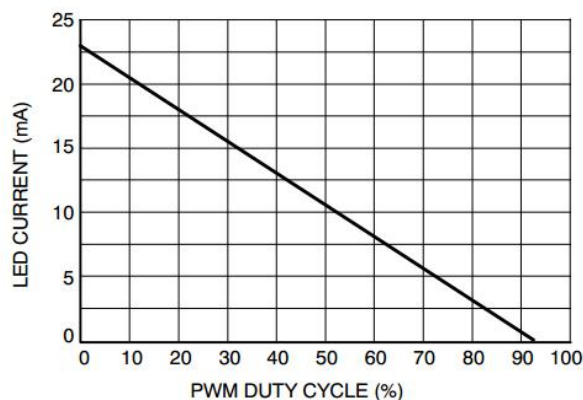
图7-3 滤波的PWM信号与灯电流的关系（0V到2.5V）
